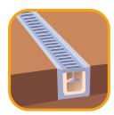
Fissare le griglie con il rispettivo sistema di ancoraggio, in modo da evitare il movimento della griglia stessa al passaggio dei veicoli. Per un corretto funzionamento del sistema, è fondamentale installare il sistema di fissaggio adeguato per ogni uso.
