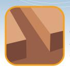
Preparare lo scavo del letto per l'alloggiamento del cemento, tenendo sempre in conto le dimensioni X, Y, Z, segnalate nella Tavola 1 (pag. 17) in funzione della classe di carico da sopportare.
